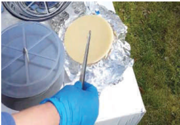
Abb. 4 Probenwechsel einer PUF-Matrix.
