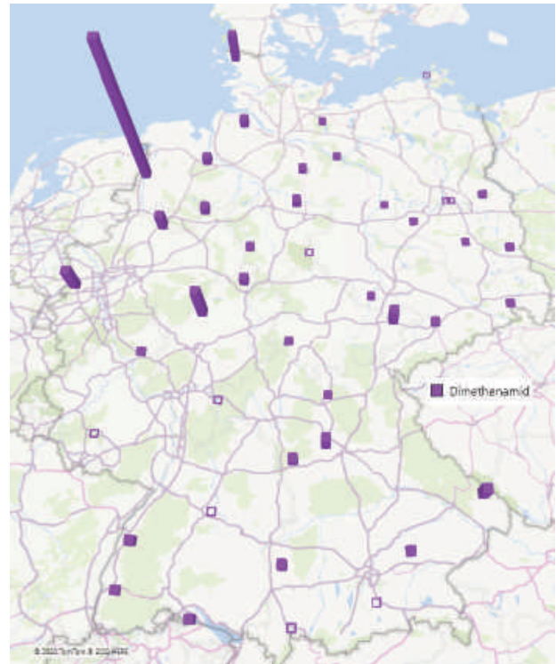
Abb. 27: Werte für Prothioconazol-desthio und Dimethenamid in Passivsammlern. Die Höhe der Balken repräsentiert den Wert am Standort in ng/Probe. Datenbasis nach ASU L 00.00-115 (Tab. 27)
