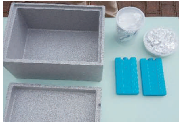
Abb 5: Beispiel der Probenentnahmegefäße und der verwendeten Kühlbox.
